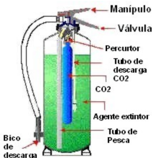
Esquema do funcionamento de um extintor de pressão não permanente
