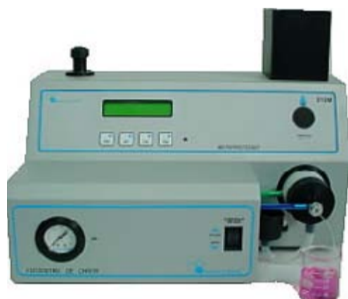
Figura – 10: Aparelho fotômetro de chama; utilizado no passado para dosagem de eletrólitos.
