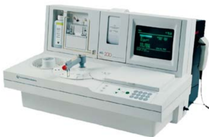
Figura – 7 Aparelho automatizado para determinação dos fatores da coagulação. Aparelho: ACL-200 Método: Nefelometria
