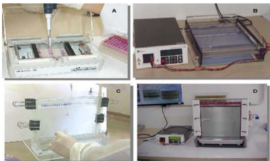
Figura – 12: Aparelho de eletroforese; utilizado para separação de proteínas.
